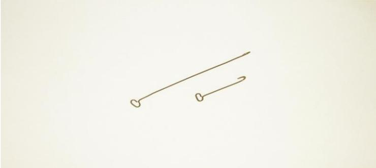
Die 2 Splinte werden geklebt an die Unterseite des Rahmens in die gebohrten Löcher. Die Entlüftung Gestänge werden durch die Splinte gesteckt und an das Entlüftungsventil festgeklebt.
