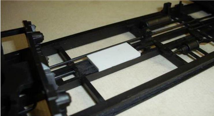
Auf diese Streife werden 2 weitere Streifen (30mm L x 10 mm B x 2 mm D) quer geklebt mit am Ende ein senkrecht stehendes Teil in PS (15 mm L x 8 mm B x 1 mm Dicke).
