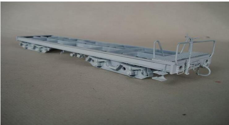
Schließlich werden die 2 Kesselsattel auf das Rahmen geklebt und wird das Rahmen wird mit den Drehgestellen in Schwarz (Ral 9017 Verkehrsschwarz) lackiert.
