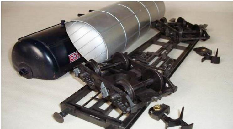
Die festen Puffer werden abgesagt. Um die Maßstab in die Länge besser zu behalten, soll man die Pufferbohle völlig abschleifen.
